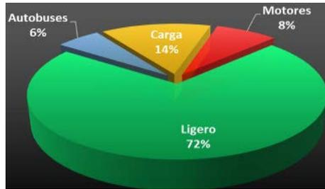
Figura 3 Composición vehicular en la intersección Av. México-Japón y Av. Tecnológico.
