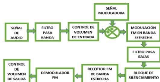
Figura 6 Diagrama a bloques del Modulador FM Narrow Band.
