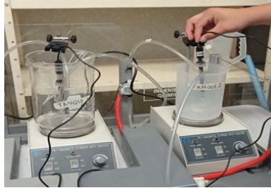
Figura 5 Posición de los conductímetros dentro de los tanques.
