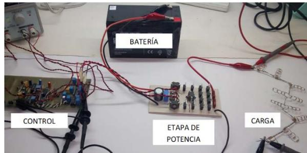
Figura 12 Circuito de control, etapa de potencia y carga.
