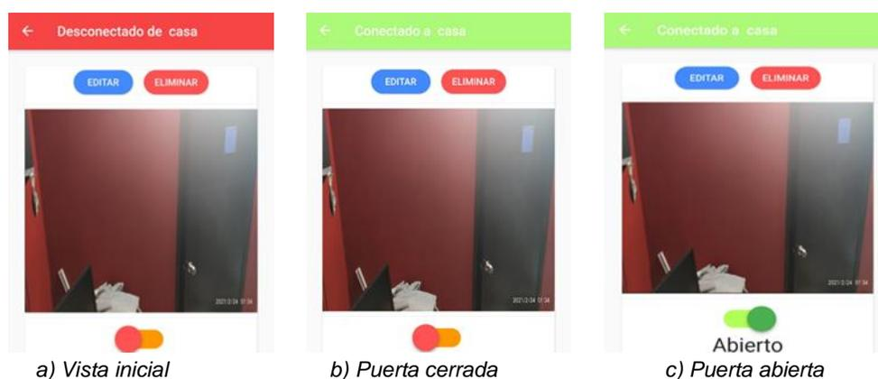
Figura 5 Estado de desconexión/conexión con cámara observando a una puerta.
