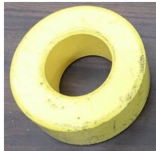
Figura 7 Núcleos para la elaboración de la bobina del boost.
