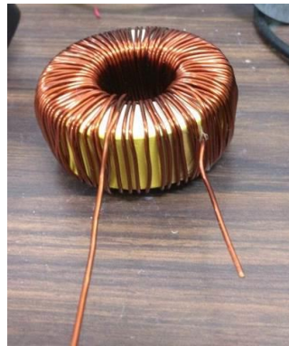
Figura 8 Bobina utilizada terminada.
