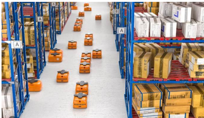
Figura 1 El AGV de Kiva utilizado por la compañía Amazon.
