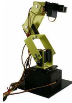
Figura 2 Brazo robótico de cuatro grados de libertad [Mohammed, 2015].
