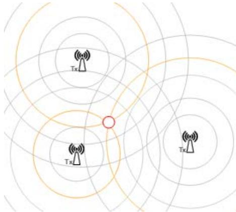
Figura 4 Punto de Intersección de Transmisores Sincronizados [22].
