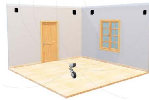
Figura 10 Localización de un Robot mediante Sensores BLE y TDoA.
