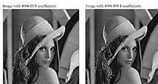
Figura 5 Compresión de imágenes con Transformada Wavelet.
