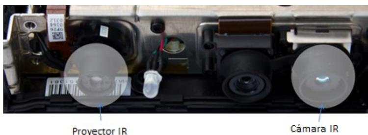
Figura 2 Elementos de la cámara de profundidad del Kinect [Miles, 2012].
