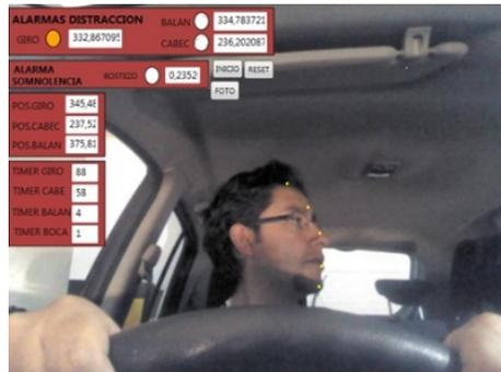
Figura 17 Alarma de distracción encendida, conducción real.
