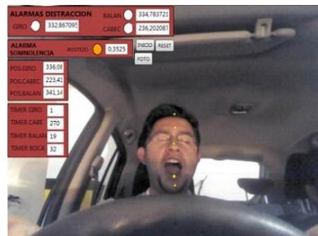
Figura 18 Alarma de somnolencia encendida, conducción real.
