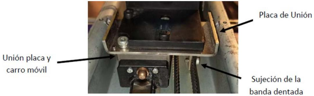
Figura 5 Unión del sistema entre guía y la banda lineal.
