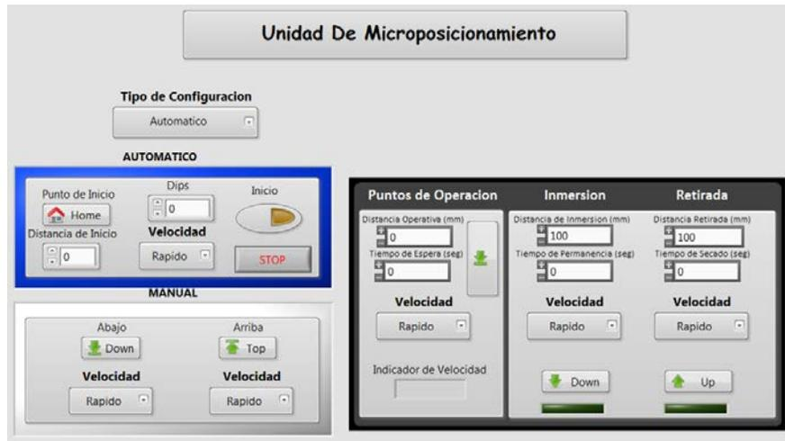
Figura 13 Interfaz de operación del usuario en LabVIEW.
