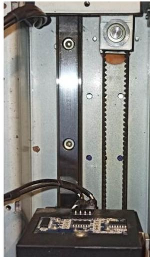
Figura 4 Mecanismo de movimiento lineal ubicado en parte superior.
