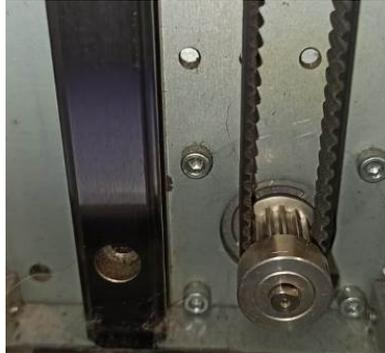
Figura 3 Mecanismo de movimiento lineal ubicado en parte inferior.
