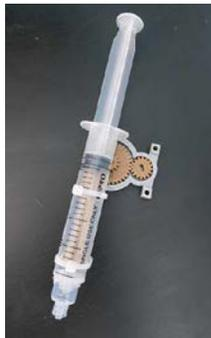
Figura 4 Posición “adentro” de inyección de pigmento con los elementos mecánicos.
