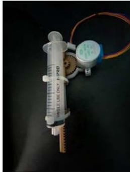
Figura 3 Elementos de suministro de pigmento acoplado el motor a la cremallera.
