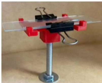
Figura 5 Base de sujeción de la celda para mantenerla fija al momento del suministro.
