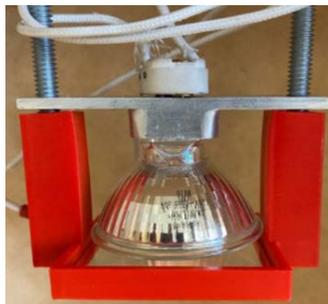
Figura 6 Base para la sujeción de la lámpara de halógeno de 50 Watts.
