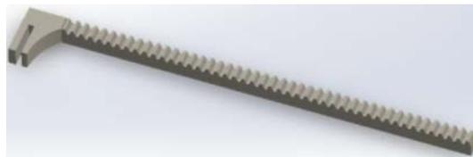
Figura 2 Cremallera diseñada para mover el émbolo de la jeringa guarda-pigmento.
