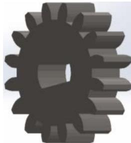
Figura 1 Engrane diseñado en SolidWorks® para adecuar torque y velocidad.
