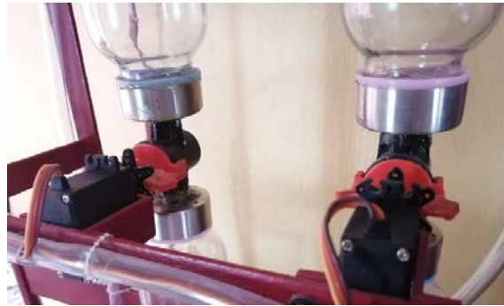
Figura 5 Válvulas mitral y tricúspide con sus respectivos servomotores.
