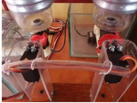
Figura 6 Válvulas aórtica y pulmonar con sus respectivos servomotores.
