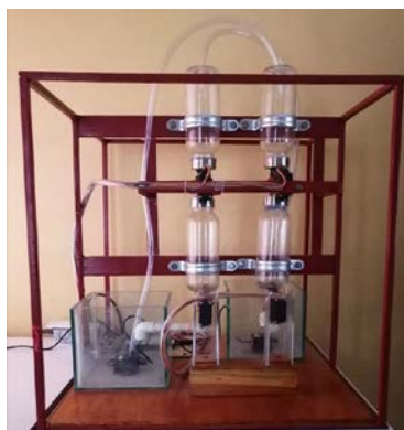
Figura 14 Prototipo experimental de un emulador del sistema hidráulico del corazón.
