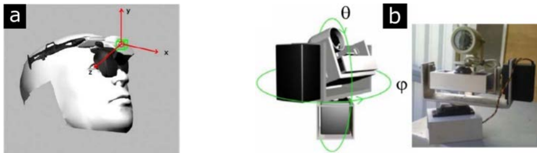
a) Representación conceptual del operador con el casco b) Plataforma PTZ y montaje de la cámara RGB.
