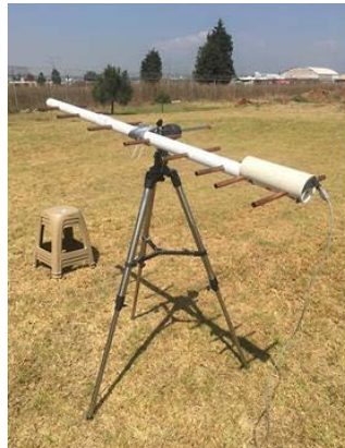
Figura 11 Una de las antenas Yagi-Uda de 8 elementos usadas durante las pruebas.
