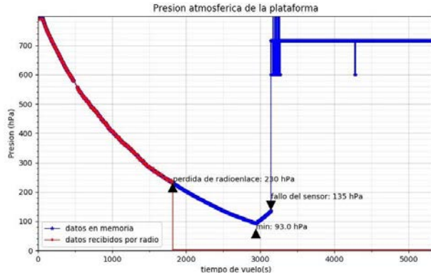
Figura 17 Mínima presión registrada y el momento de falla del sensor.
