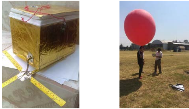
a) Sonda terminada. b) Inflado del globo y ajuste de la sonda
