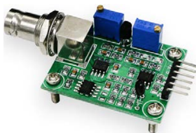
Figura 1 Módulo sensor de pH SEN0161.
