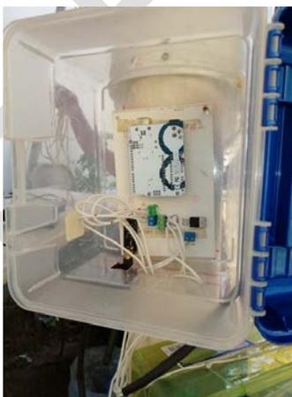
Figura 4 Tarjeta de lectura de sensores y envío de datos.
