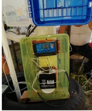
Figura 9 Sistema de carga solar.
