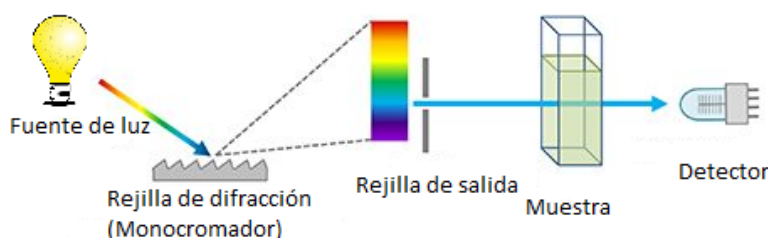
Figura 3 Diagrama esquemático del sistema de caracterización UV-Vis.
