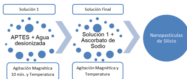
Figura 1 Proceso de la reacción usada para la síntesis de nanopartículas de silicio.
