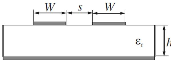
Figura 2 Sección transversal de líneas de microcinta acopladas.
