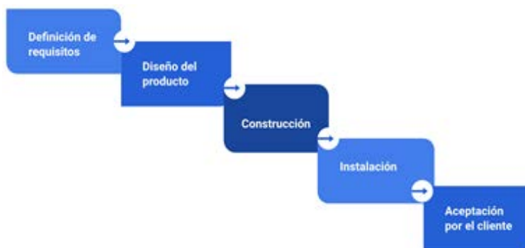
Figura 6 Ciclo lineal para un proyecto de automatización.
