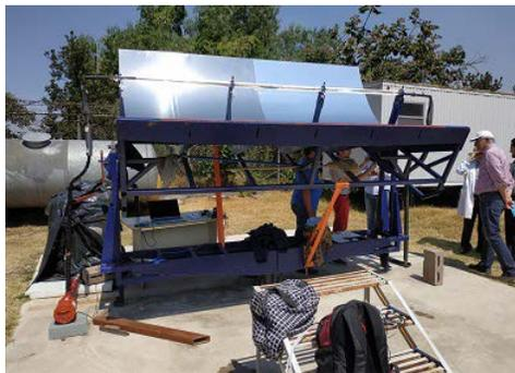
Figura 10 Seguidor solar para precalentamiento de fluidos de trabajo.
