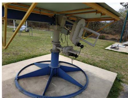
Figura 11 Helióstato experimental.
