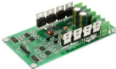
Figura 3 Puente H dual MOSFET para control de motor de corriente directa de 3 a 36 V.
