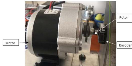
Figura 2 Motor de corriente directa conectado mecánicamente a un encoder absoluto.
