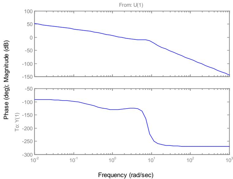
Figura 5 Gráfica de bode de la segunda función de transferencia que produce MATLAB.
