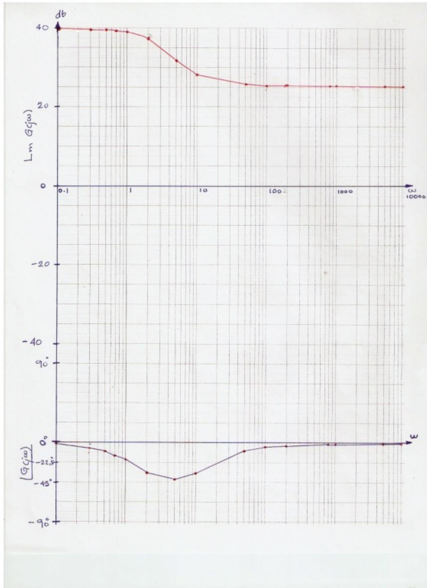
Figura 2 Gráfica de puntos obtenidos de la primera función de transferencia.
