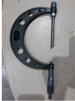
Figura 2 Micrómetro Mitutoyo.
