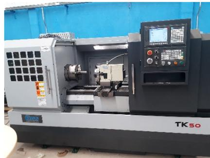
Figura 2 Torno CNC horizontal.
