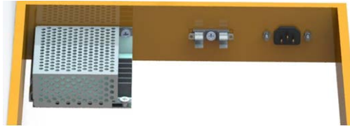
Figura 10 Vista de los elementos asociados a la alimentación eléctrica del equipo.
