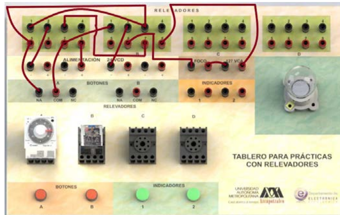
Figura 16 Implementación en el tablero de un circuito de control de lazo abierto.
