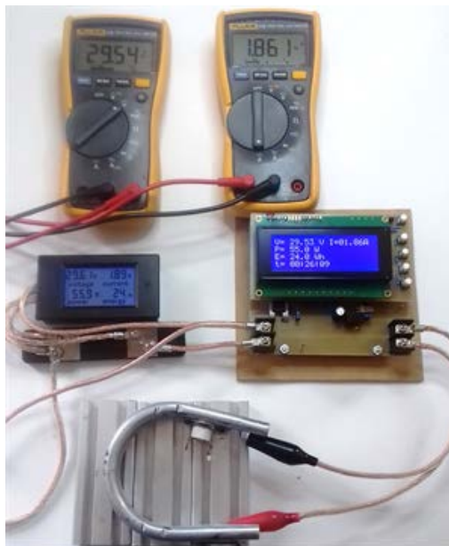
Figura 8 Arreglo propuesto para validar el Watthorímetro.
