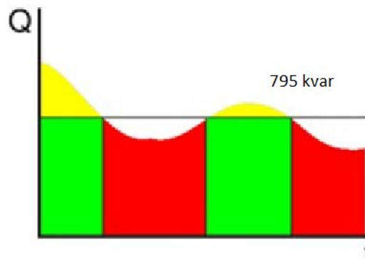
Figura 7 Sobre y Sub compensación, por compensación fija igual a 795 kVAr.
