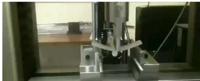
Figura 5 Prueba de flexión en 3 puntos en probeta de polipropileno.
