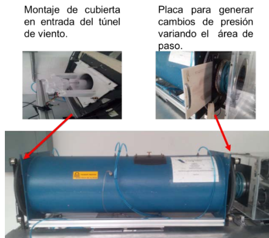
Figura 2 Arreglo para adquisición de valores experimentales en túnel de viento.
