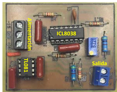
Figura 6 Implementación del circuito generador de onda triangular.
