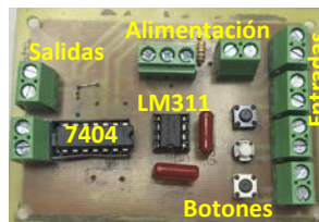
Figura 10 Implementación de la tarjeta de comparación.
