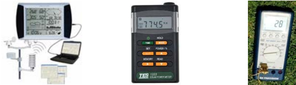
a) Estación meteorológica. b) Medidor de irradiación solar. c) Multímetro digital y termopar tipo K. Fuente: Elaboración propia
