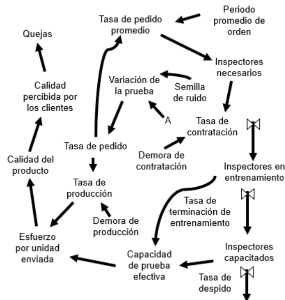
Figura 3 Modelo de simulación de "Future Electronics Company" con enfoque sistémico.
