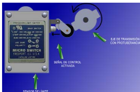
Figura 7 Sensor de giro y protuberancias en el vástago con cuchillas.
