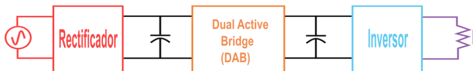
Figura 2 Elementos de un transformador de estado sólido.
