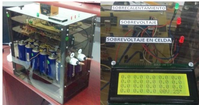
Figura 13 Prototipo de banco de supercapacitores.
