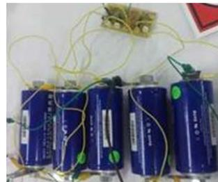
a) balanceo de voltajes pasivo con diodos. b) balanceo de voltajes activo con amplificadores
