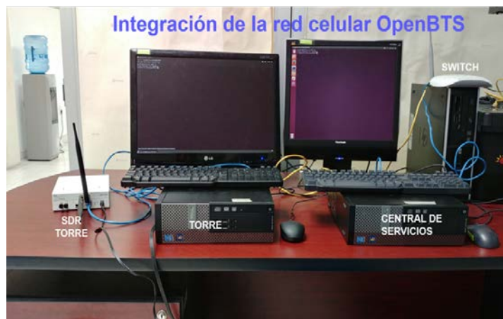
Figura 2 Implementación de la estación base GSM basada en OpenBTS y SDR.
