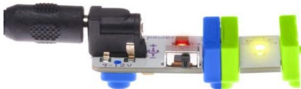
Figura 10 LED amarillo brillante y módulo de alimentación.
