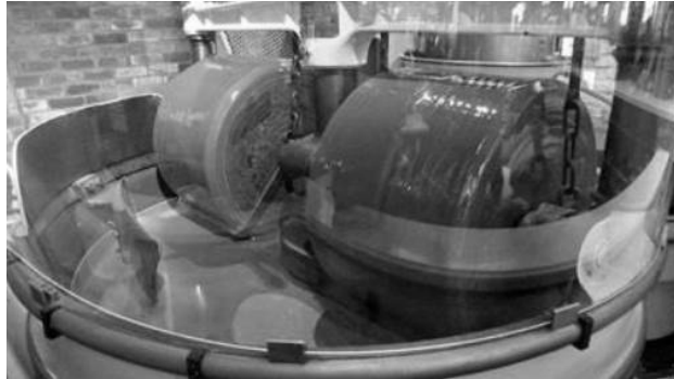
Figura 3 Conche continuo por piedras o rodillos.
