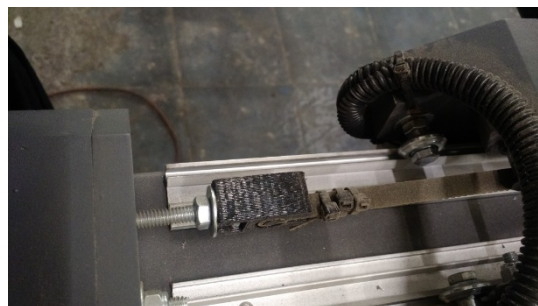
Figura 38 Acomodo de banda en polea y baleros de sujeción eje Y.
