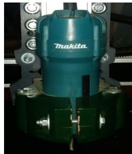
Figura 40 Acomodo del Router en su base.
