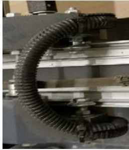
a) Acomodo de poliducto en eje Y.
