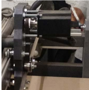
a) Acomodo de poliducto en eje X.
