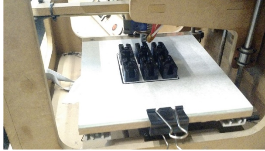
Figura 36 Impresora 3D haciendo sujetadores de banda.
