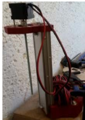
Figura 33 Torre del eje Z.
