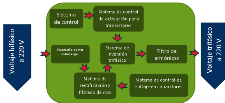
Figura 2 Requerimientos del proyecto.
