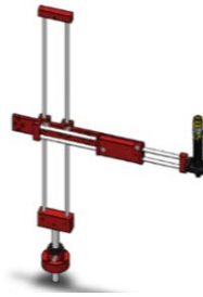
Figure 2 Brazo ergonómico diseñado en SolidWorks.
