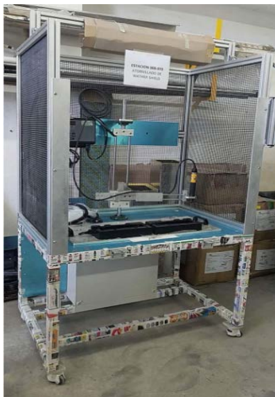
Figure 7 El brazo ergonómico ya ensamblado en la mesa de trabajo.
