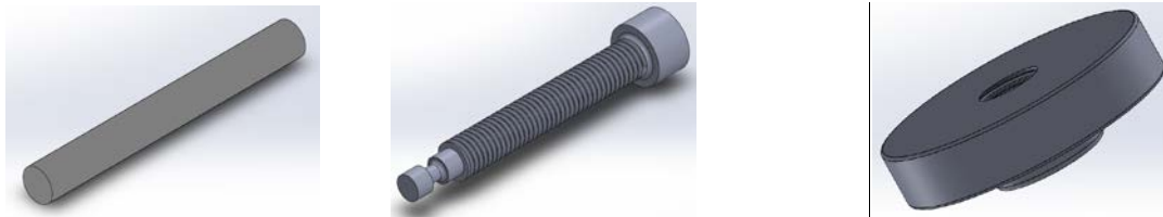
d) Guías de nivelador AISI-1020. e) Tornillo A2 resistencia 8.8 paso 1.5. f) Rueda moletada RVK 0.8 DIN 82 AISI-1020.
