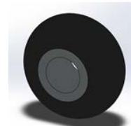
f) Perilla AISI 1020 con cubierta de neopreno.
