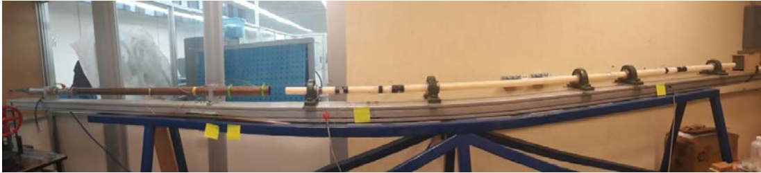
Figura 3 Sistema Barra de Hopkinson con barras de Nylon.
