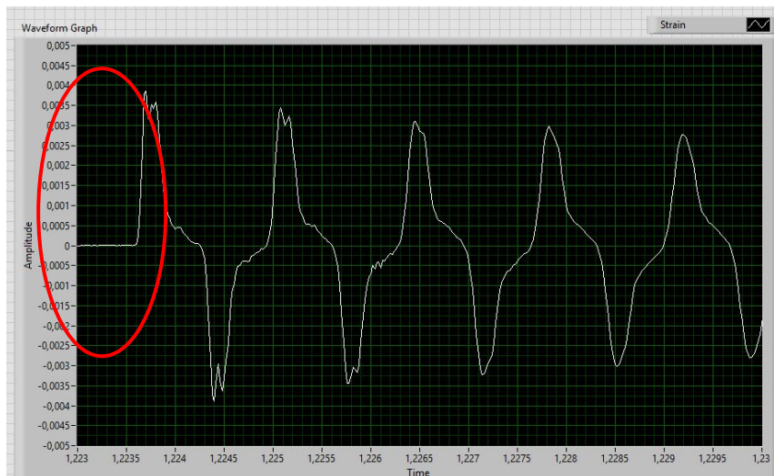
Figura 7 Respuesta de la barra transmisora.
