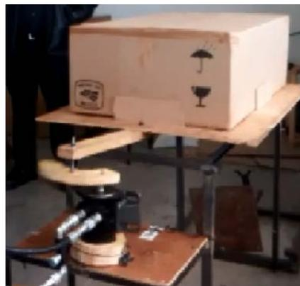
Figura 3 Máquina de vibración.
