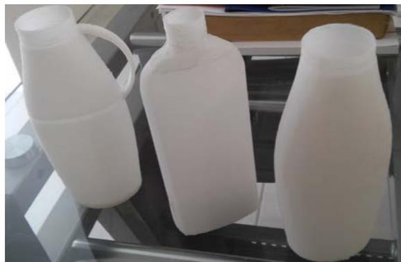
Figura 2 Impresión de algunos prototipos de botella a escala.
