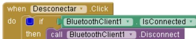
Fig. 9. Cierre de conexión.
