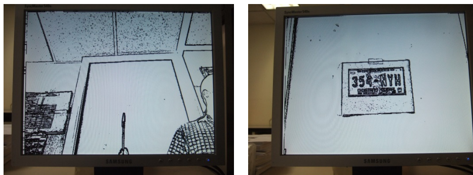
Fig. 11. Fotos de imágenes después de aplicar el filtro Sobel, izquierda una persona mostrando un bolígrafo y derecha, placa impresa en una hoja.
