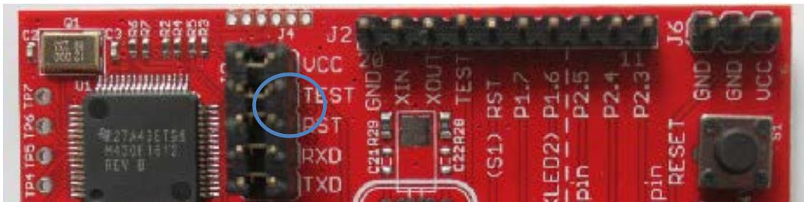
**Fig. 3. Adaptación de TXD y RXD.**
