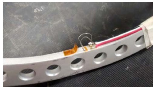
Fig. 21. Desprendimiento del strain-gage por grandes deformaciones.
