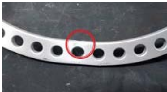
Fig. 10. Deformaciones plásticas y estricción de la zona de apoyo y aplicación de carga.
