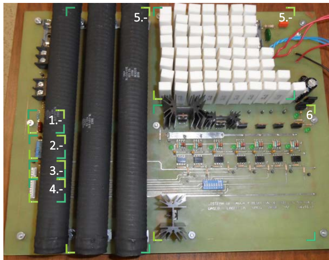
Fig. 3. Circuito de prueba. 1- Sensor de tensión, 2- Sensor de corriente, 3- Salidas Analógicas, 4-Entradas digitales, 5- Grupo de resistencias, 6- Interruptores.
